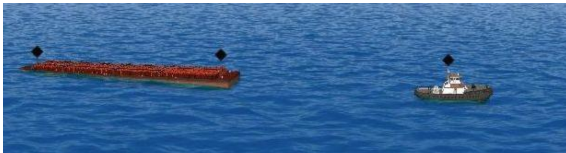
Rys. 143. Statek holujący i obiekt częściowo zalewany o długości obiektu > 250 m, podczas dnia.
